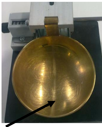
Fig. 59 - Sulco de desgaste marcado na concha.
