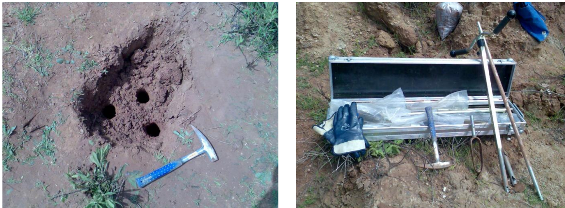
Fig. 36 - Trado manual para recolha de amostras em profundidade do solo 2.
