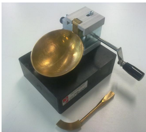
Fig. 44 - Dispositivo de concha de Casagrande usado nos ensaios.
