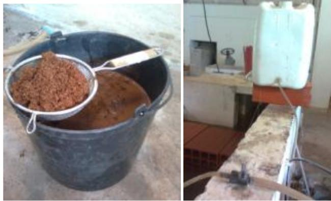
**Figura 26 – Introdução de *seeding* no escoamento. Lado esquerdo, preparação da concentração de casca de avelã; lado direito, reservatório a montante do canal.**
