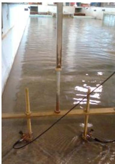
**Figura 24 – Apoio fixo para os transdutores**
