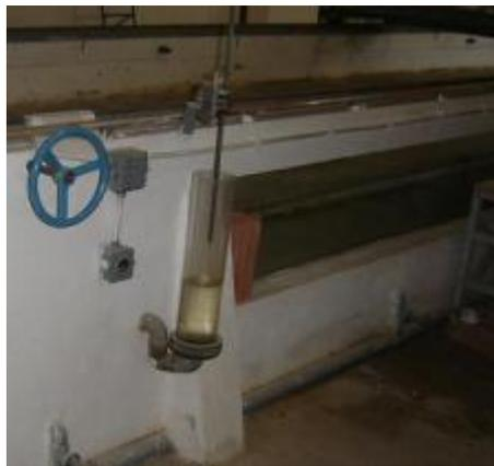
**Figura 15 – Reservatório com hidrómetro com ligação ao fundo do canal**
