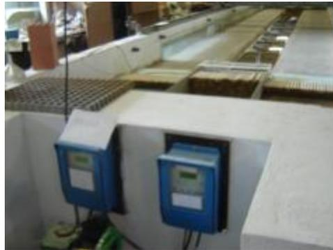
Figura 16 – Caudalímetros situados no início do canal
