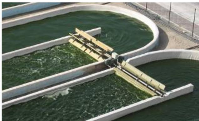
FIGURA 5-3 – A) VISTA AÉREA DE UM ESQUEMA DE TANQUE DE PRODUÇÃO DE MICROALGAS (SISTEMA ABERTO)
