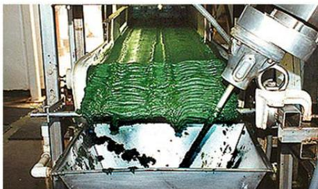
FIGURA 8-7 - PARTE DO PROCESSO DE COLHEITA DE BIOMASSA DE MICROALGAS ATRAVÉS DE FILTRAÇÃO EM CINTOS ROLANTES (*CYANOTECH* – HAVAI) (Chisti, 2007)
