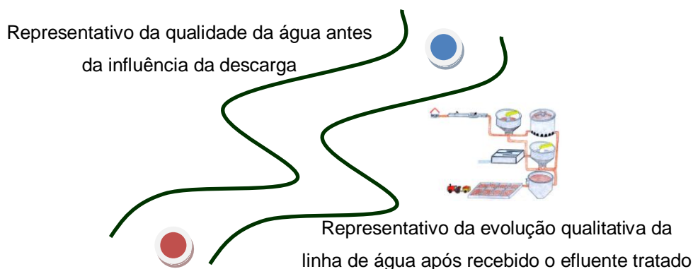
Figura 5.18 - Localização esquemática dos pontos de amostragem (a azul: ponto de montante; a vermelho: ponto de jusante)
