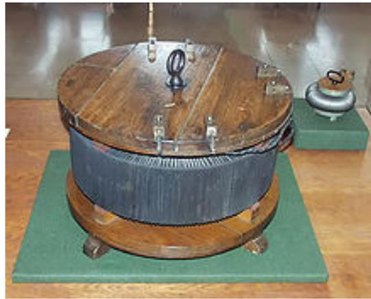
**Figura 3.4 - Transformador GANZ “ZBD”(1884-1885); Protótipo do primeiro transformador de elevado rendimento (Museum of Applied Arts, Budapeste)**
