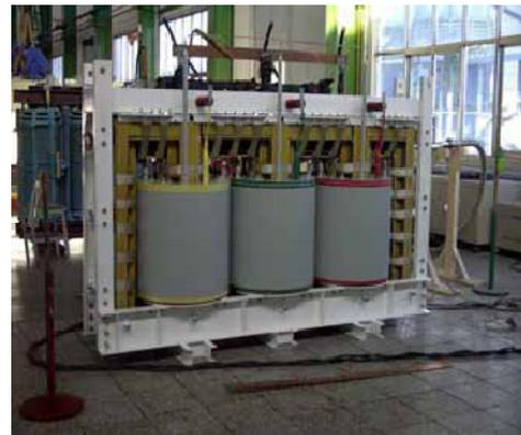
**Figura 3.6 - Transformador trifásico supercondutor**
