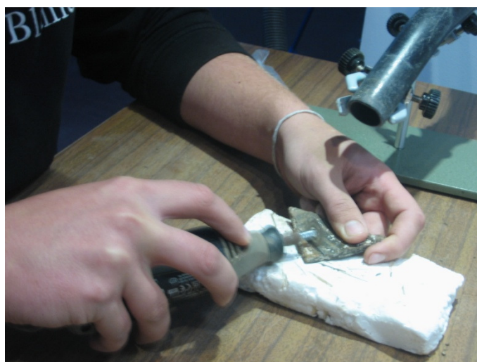
Fig. 1 – Recolha de amostras com máquina de corte de motor de rotação com disco de diamante.
