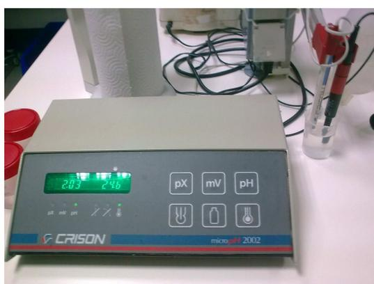
Figura 5.2 – Potenciómetro (medidor de pH).
