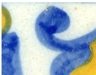
Figura 3.7. Pormenor da amostra SCT14, ilustrando a transparência da cor azul. Este surge mais escuro nos locais onde as pinceladas se sobrepõem.
