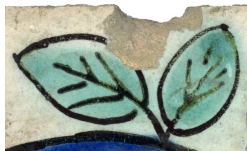
Figura 3.22. Pormenor da amostra SCT29 onde se observa a difusão da decoração a verde.
