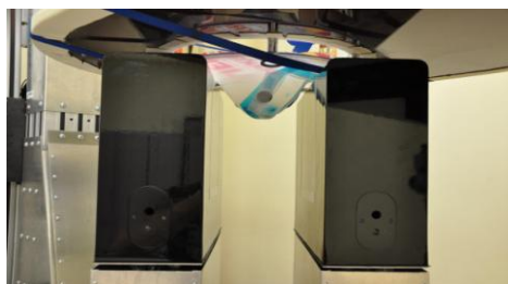
Figura 7.2 – Imagem do fantoma de gelatina durante a sua aquisição no protótipo Clear – PEM.
