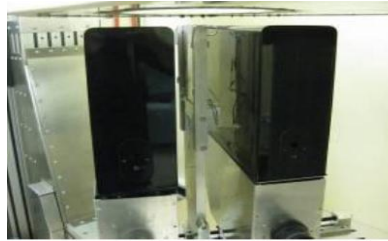
Figura 7.3 – Imagem do fantoma da fonte planar durante a sua aquisição no protótipo Clear – PEM.
