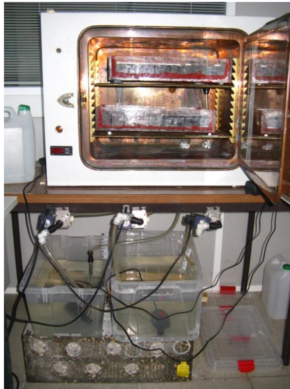
Figura 5.2 – Câmara climática de envelhecimento artificial.
