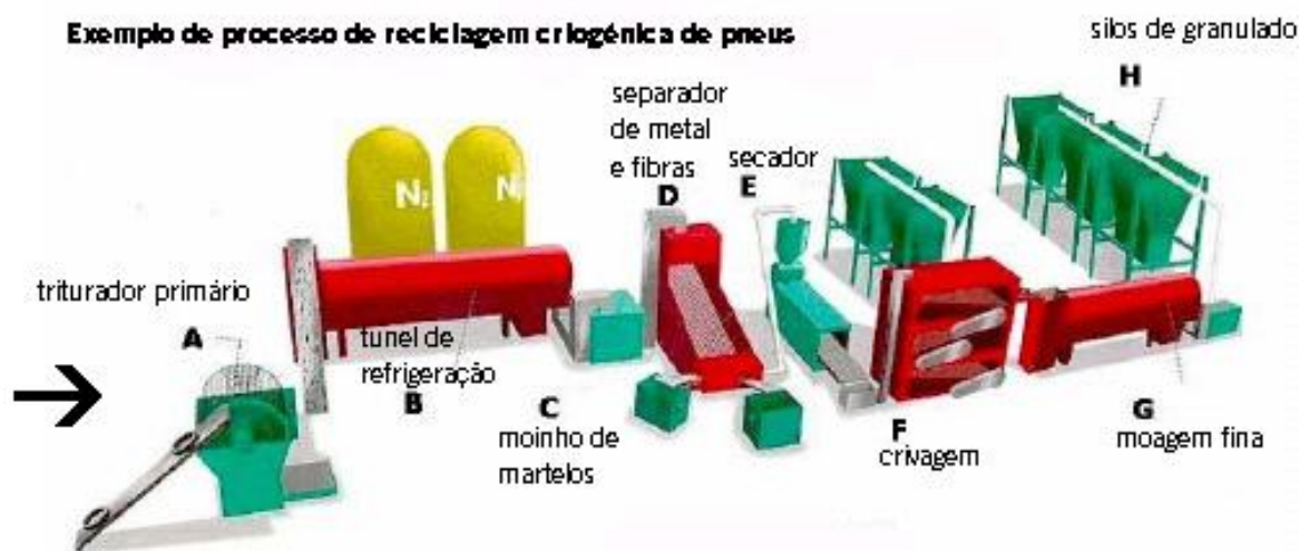
Figura 4.8 - Processo-tipo de reciclagem criogénica [76]
