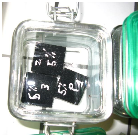
Figura 5.8 – Exemplo de provetes imersos numa solução de ácido sulfúrico.
