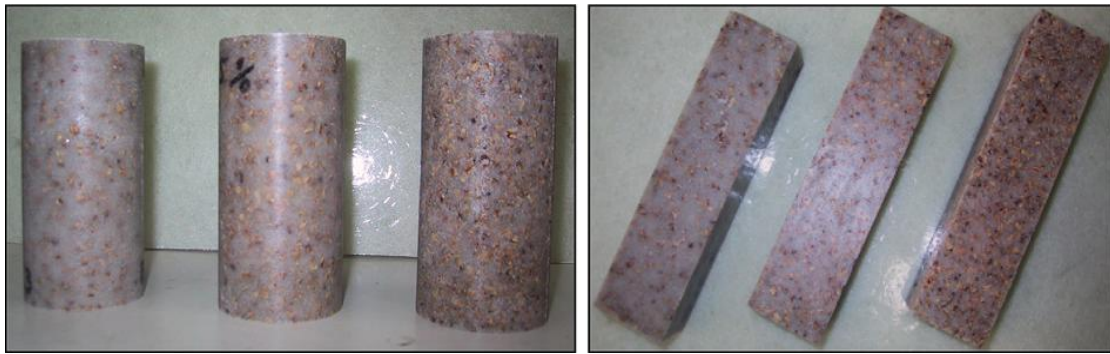
Figura 3.8 – Alguns exemplos de provetes cilíndricos e prismáticos produzidos de betão polimérico modificado com cortiça [36].
