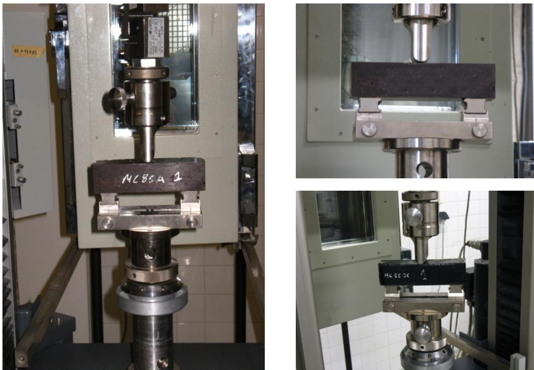
Figura 5.10 – Pormenores do ensaio à tracção por flexão.
