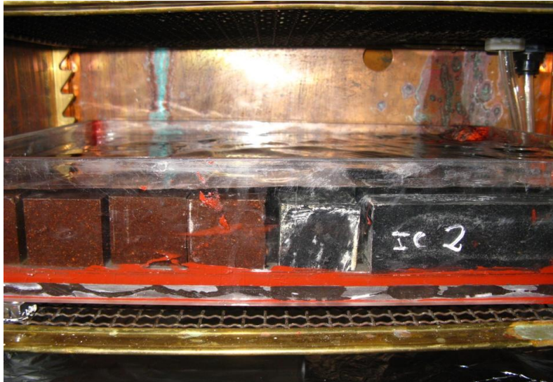
Figura 5.5 – Pormenor do enchimento dos tabuleiros durante os ciclos de imersão no interior da câmara climática.
