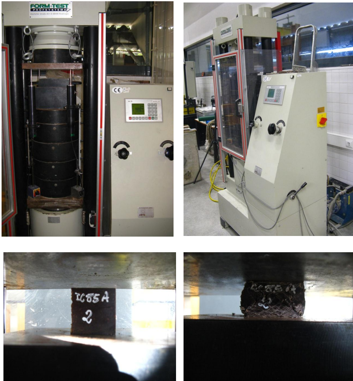
Figura 5.11 – Pormenores do ensaio à compressão monotónica.
