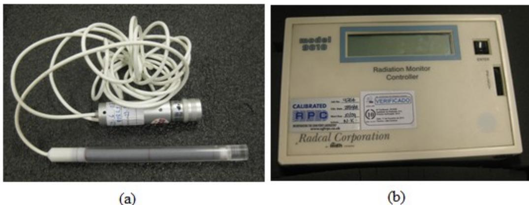
**Figura 16** – (a) Câmara de ionização tipo lápis modelo 10×5 – 3CT e (b) monitor do electrómetro modelo 9010.
