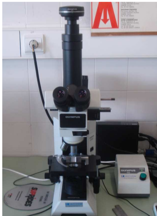
Figura 4.19 - Microscópio Olympus modelo CX40RF200, com câmara acoplada, modelo DP21 U-CMAD3 onde se realizaram as micrografias.
