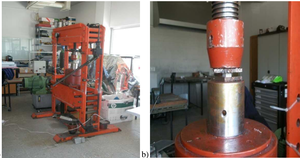
Figura 4.4 – Equipamento e Processo de deformação; a) Prensa Hidráulica; b) Processo de deformação plástica.
