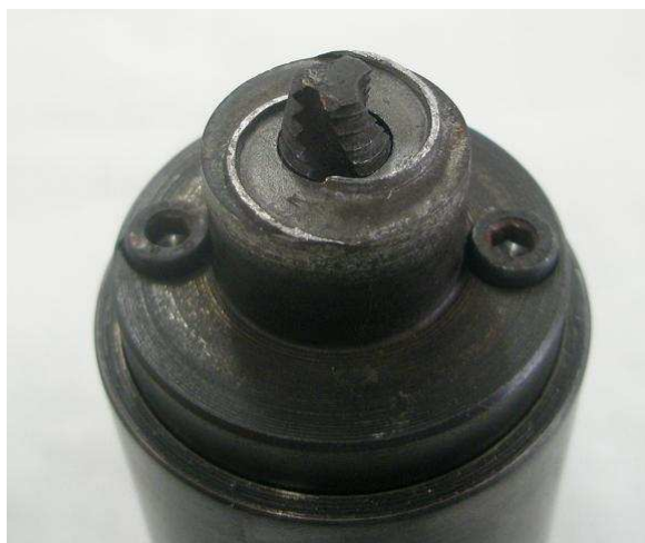
Figura 4.6 - Ferramenta de Fricção Linear utilizada em todos os ensaios de PFL
