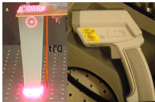
Fig. 2.33 - (A) Medição da temperatura ao longo do concentrador através de (B) um termómetro digital da marca Thorlabs.
