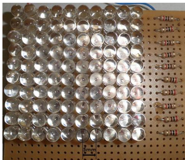
Fig. 2.17 - Fonte constituída por uma matriz de LEDs 10 \times 10 , com espaçamento de 5mm entre centros.
