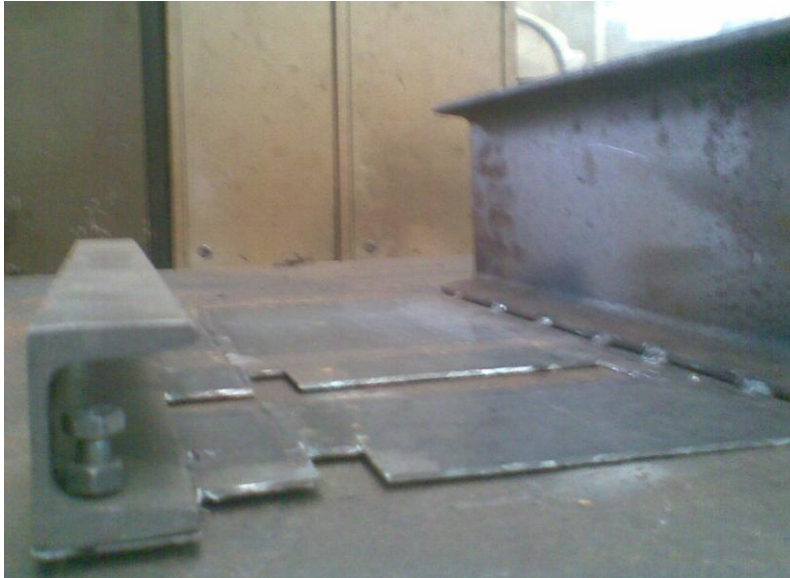
Figura 25 – Deformações existentes após o corte dos quadrados de chapa
