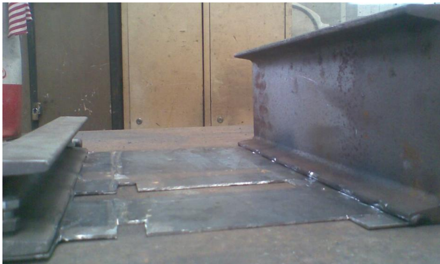
Figura 26 – Estado final da chapa após alívio do constrangimento – vista 1
