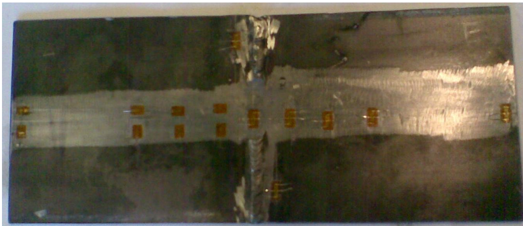
Figura 18 – Provete de 2 mm instrumentado
