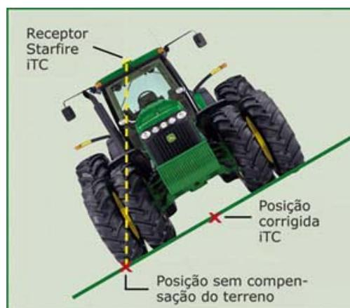
Figura 10 - Esquema da compensação do terreno (JOHN DEERE, 2009)
