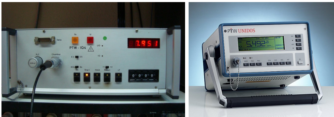
Figura IV.6 – Electrómetros utilizados no trabalho experimental realizado no LMRI – modelo IQ4 (à esquerda) e modelo UNIDOS (à direita), ambos da marca PTW.
