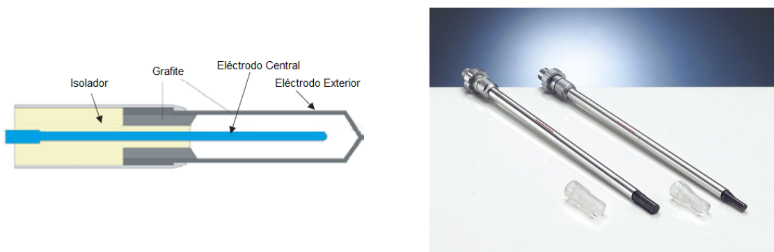
Figura IV.3 – Câmara de ionização cilíndrica – Representação esquemática (à esquerda) e dois exemplos deste tipo de detector (à direita).
