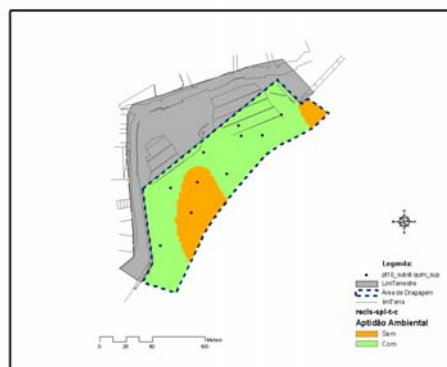
Figura 167. Superfície de classificação da aptidão ambiental dos sedimentos dragados para a imersão no mar, obtida a partir da interpolação Spline-T
