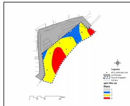
Figura 159. Superfície de classificação do risco potencial de poluição do meio marinho pelos sedimentos dragados, obtida a partir da interpolação Spline-T
