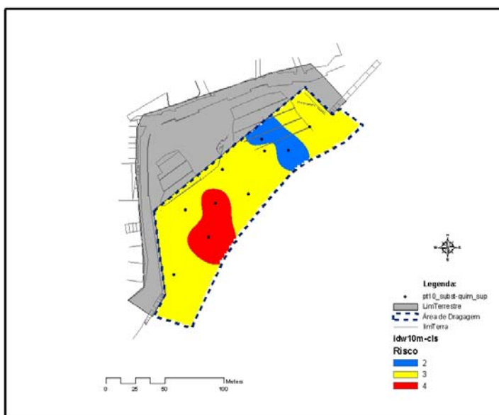
Figura 68. Superfície de classificação do risco potencial de poluição do meio marinho.
