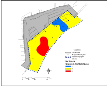
Figura 150. Superfície de classificação dos valores estimados das classes de contaminação dos sedimentos dragados obtida a partir da interpolação IDW
