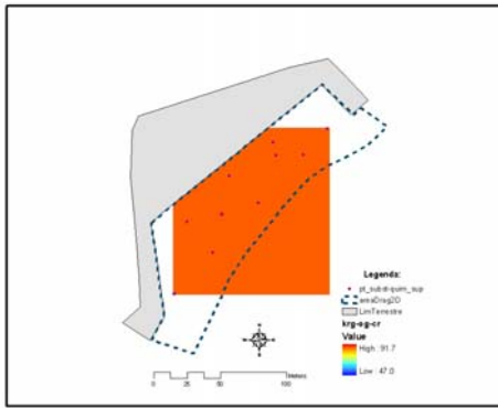
Figura 66. Superfície de interpolação do valor de concentração de Cr nos sedimentos dragados gerada pelo interpolador KRIG-OG
