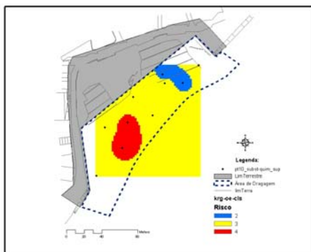
Figura 162. Superfície de classificação do risco potencial de poluição do meio marinho pelos sedimentos dragados, obtida a partir da interpolação KRIG-OE
