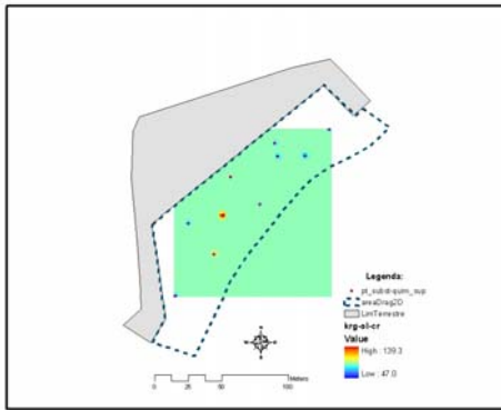
Figura 68. Superfície de interpolação do valor de concentração de Cr nos sedimentos dragados gerada pelo interpolador KRIG-OL
