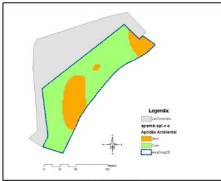
Figura 168. Superfície de classificação da aptidão ambiental dos sedimentos dragados para a imersão no mar, obtida a partir da interpolação Spline-R
