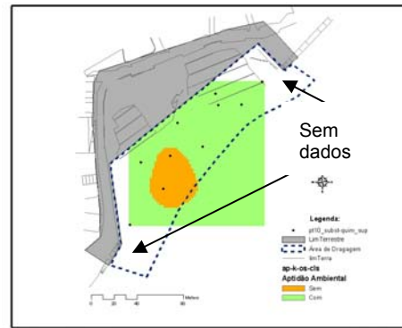
Figura 51. Superfície de aptidão ambiental dos materiais dragados para a imersão no mar, obtida da classificação da superfície de estimacão gerada pelo interpolador KRIG-OS .
