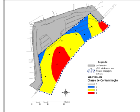
Figura 151. Superfície de classificação dos valores estimados das classes de contaminação dos sedimentos dragados obtida a partir da interpolação Spline-T
