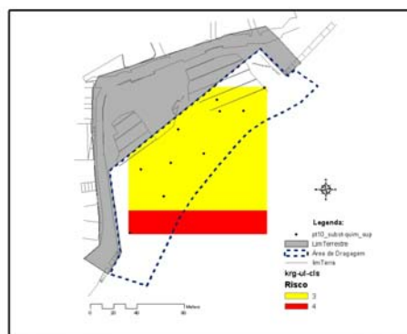
Figura 163. Superfície de classificação do risco potencial de poluição do meio marinho pelos sedimentos dragados, obtida a partir da interpolação KRIG-OG
