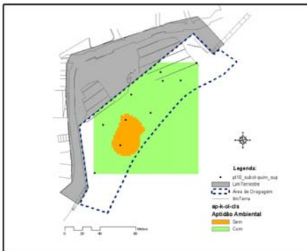
Figura 172. Superfície de classificação da aptidão ambiental dos sedimentos dragados para a imersão no mar, obtida a partir da interpolação KRIG-OL
