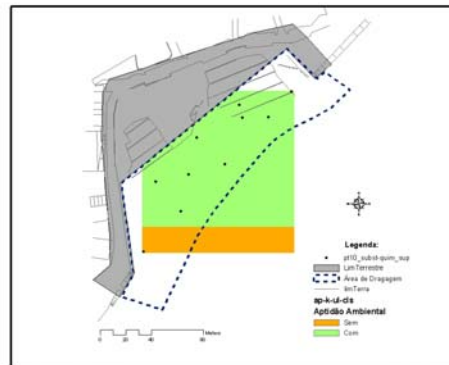
Figura 173. Superfície de classificação da aptidão ambiental dos sedimentos dragados para a imersão no mar, obtida a partir da interpolação KRIG-UL
