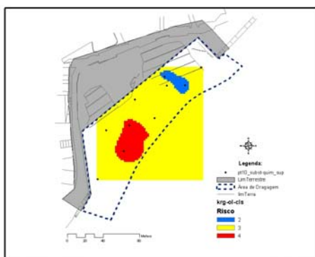
Figura 162. Superfície de classificação do risco potencial de poluição do meio marinho pelos sedimentos dragados, obtida a partir da interpolação KRIG-OE
