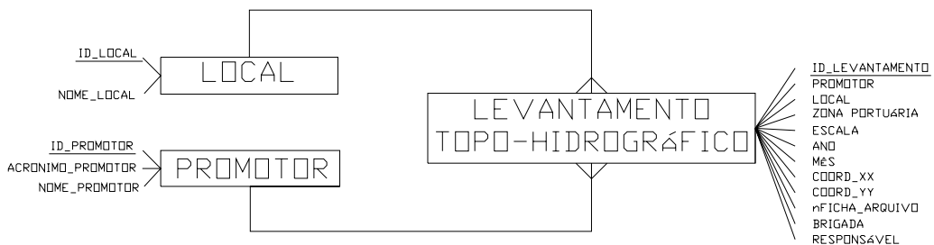
Figura 37. SUB-DIAGRAMA DEA: promotor – local – levantamento topo-hidrográfico, adaptado de DIAS, E. (2003a).
