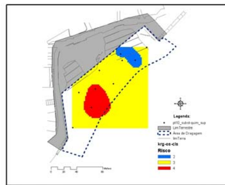
Figura 159. Superfície de classificação do risco potencial de poluição do meio marinho pelos sedimentos dragados, obtida a partir da interpolação Spline-T
