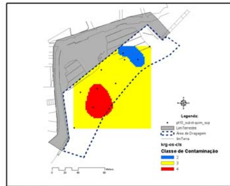
Figura 151. Superfície de classificação dos valores estimados das classes de contaminação dos sedimentos dragados obtida a partir da interpolação Spline-T
