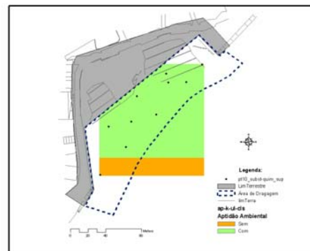
Figura 53. Superfície de aptidão ambiental dos materiais dragados para a imersão no mar, obtida da classificacão da superfície de estimacão gerada pelo interpolador KRIG-OG .
