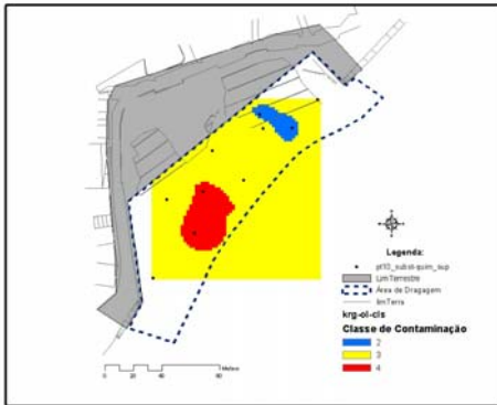
Figura 156. Superfície de classificação dos valores estimados das classes de contaminação dos sedimentos dragados obtida a partir da interpolação Krig-OL
