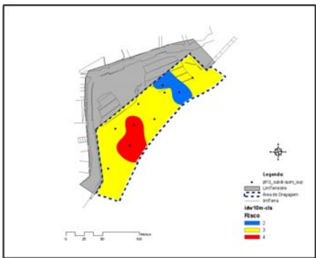
Figura 158. Superfície de classificação do risco potencial de poluição do meio marinho pelos sedimentos dragados, obtida a partir da interpolação IDW
