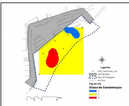
Figura 152. Superfície de classificação dos valores estimados das classes de contaminação dos sedimentos dragados obtida a partir da interpolação Spline-R
