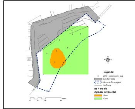
Figura 169. Superfície de classificação da aptidão ambiental dos sedimentos dragados para a imersão no mar, obtida a partir da interpolação KRIG-OS
