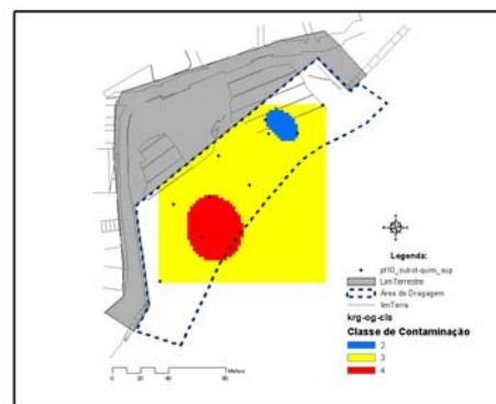
Figura 153. Superfície de classificação dos valores estimados das classes de contaminação dos sedimentos dragados obtida a partir da interpolação KRIG-OS
