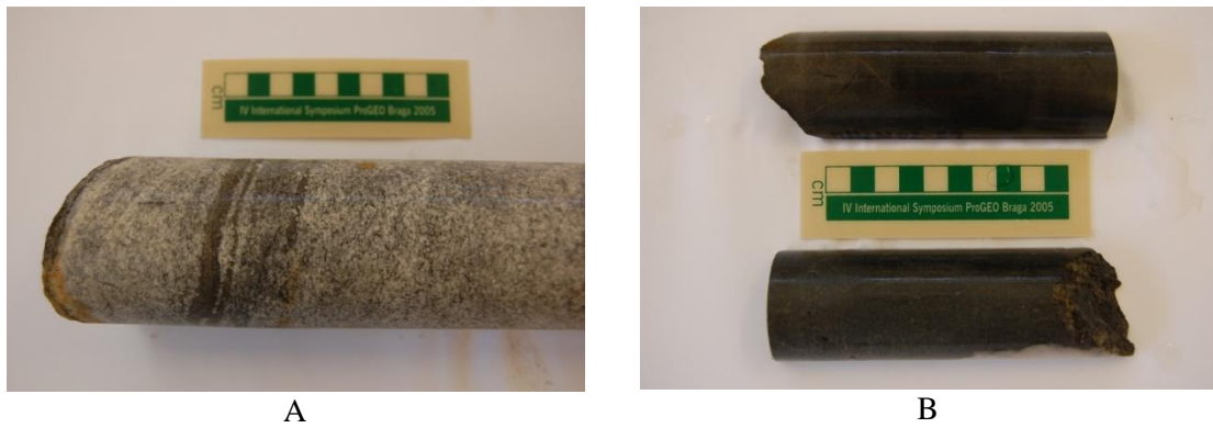
Figura 3.6 – Amostras de carotes de sondagens colhidas no sector de Casas Novas ilustrativas dos diques leucocráticos (A) e mesocráticos e melanocráticos (B). Na foto A observar a preservação de bandas isoladas do material xistento encaixante, preservadas no granitóide.
