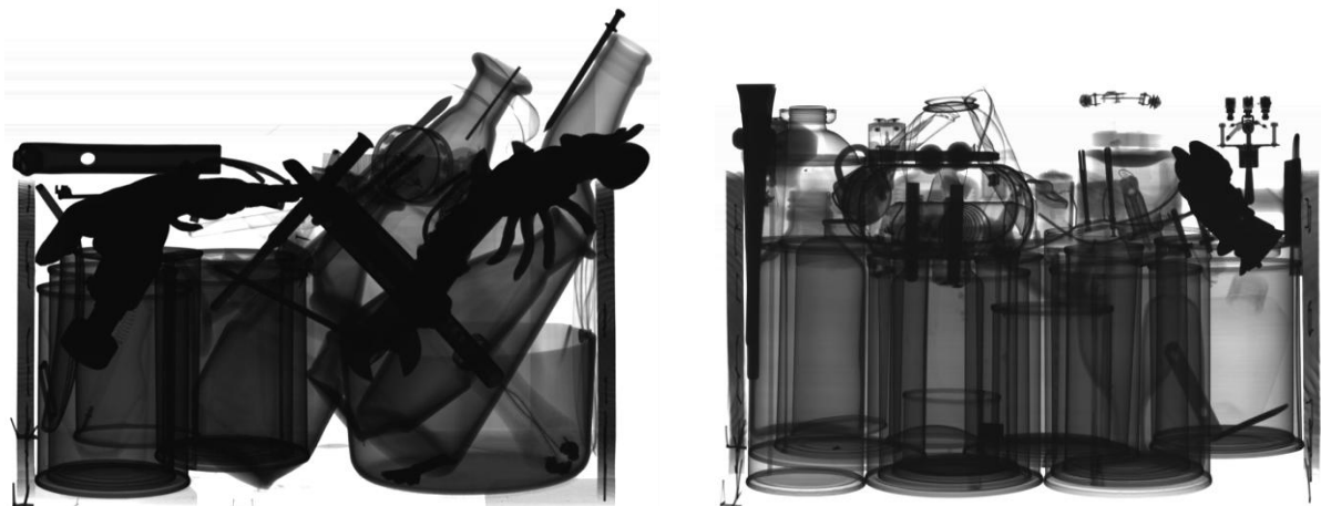
Figura 3: Radiografias digitais das peças. À esquerda Caixa de Alumínio (Lagostins) , vista lateral esquerda, voltagem 90kV. À direita Caixa de (Óculos) , vista lateral esquerda, voltagem 130kV.
