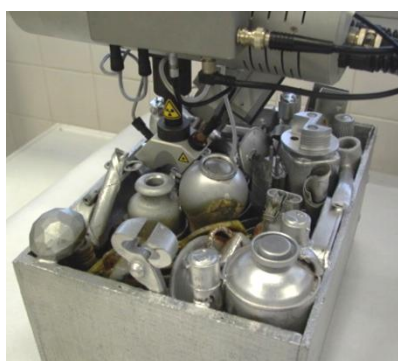
Figura 17: Análise por XRF. À esquerda, um dos momentos da análise de Caixa de Alumínio (Óculos) : é possível observar as dificuldades experimentadas devido à forma da obra e o tamanho da cabeça de detecção do aparelho. À direita, exemplo de um dos espectros obtidos para a mesma obra, o espectro do objecto L2.
