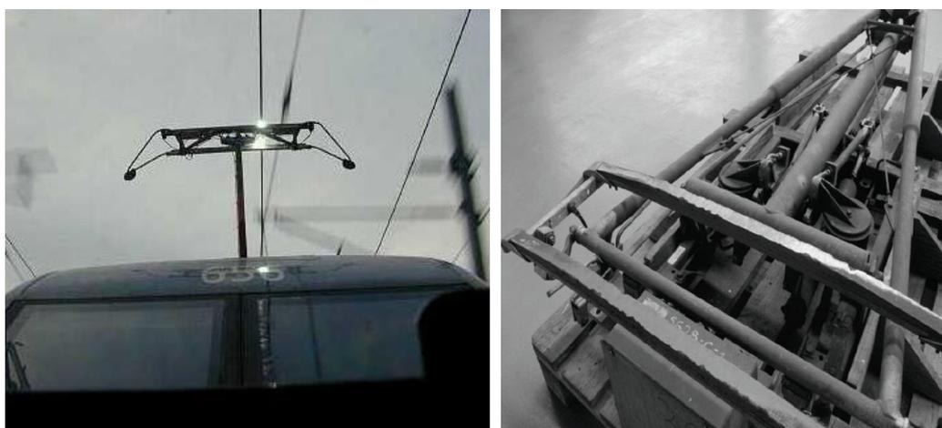
Figura 2.7 – Esquerda: pantógrafo a deslizar ao longo do fio de contacto [11].
