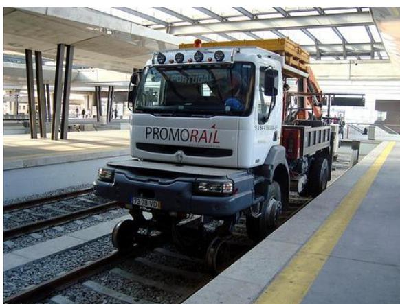
**Figura 1.1. - Veículo auxiliar da *PromoRail* na construção das catenárias.**
