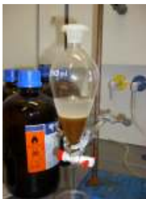
Figura 2.25: Extração da fase insaponificável com ampola de decantação.
