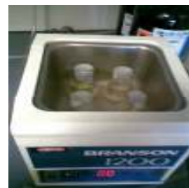
Figura 2.13: Agitação das amostras no aparelho ultra-sons.
