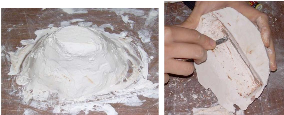
Fig.19: Elaboração do molde negativo em gesso para seguidamente se efectuar a peça positiva em vidro.
