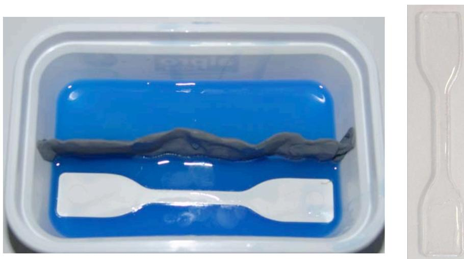
Fig. 1.1: Preparação dos moldes em forma de alter utilizando silicone de dentista e provete final em resina (leitura das imagens da esquerda para a direita).
