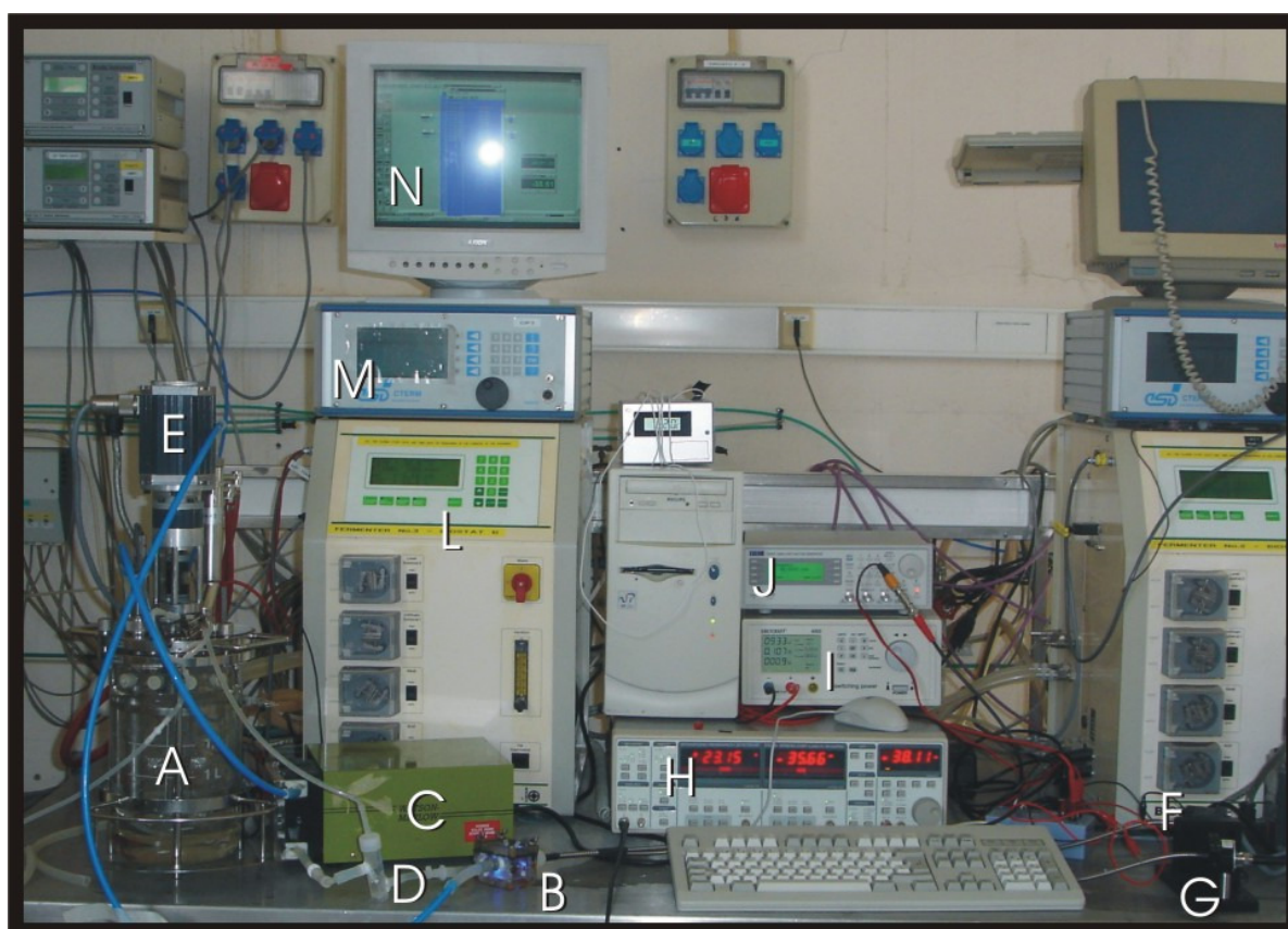
Figura 9.15 – Disposição do equipamento e instrumentação utilizados na determinação dos parâmetros de Stern-Volmer.: A- vaso com água; B- caixa de suporte de amostras; C- bomba peristáltica; D- dispositivo para remoção de bolhas; E- agitador; F- LED; G- fotodetector; H-Lock-in; I- Fonte de alimentação do LED; J- Gerador de funções; M-Controlador de caudais de gases de borbulhamento e temperatura; N- Visualização para registo de resultados.
