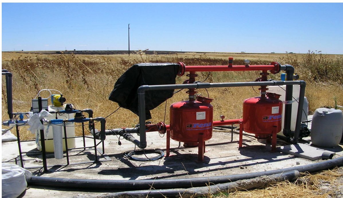
Fig 3.1: Sistema de tratamento testado nos ensaios piloto (Jan – Feb 2004): Bombagem ( 2\text{m}^3/\text{h} ) → pré-filtração (filtro malha 130\ \mu\text{m} ) → coagulação (injecção) → filtração leito curto (antracite e sílica) → desinfecção com hipoclorito de sódio (injecção).
