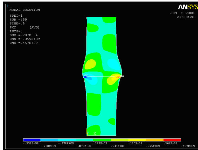
Figura XXV - Tensões residuais de corte XY do provete 7B
