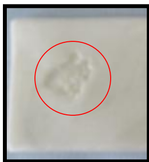
Figura 27 – Penso com defeito depois do ciclo de liofilização com a segunda prateleira.
