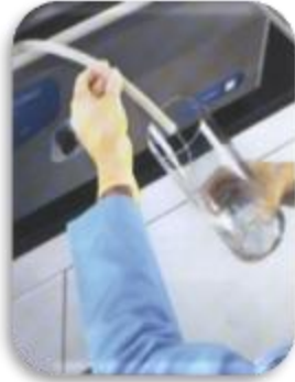
Figura 60 - Tubo drenagem do colector.
