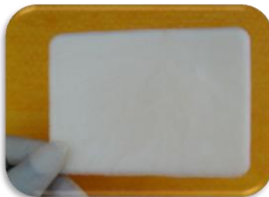
Figura 21 – Pensos hemostáticos após o primeiro ciclo de liofilização (5%CS Cognis S 2% AcA)
