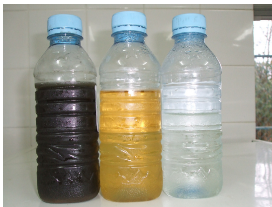
Figura 9-2 – Aspecto visual da água ruça e dos efluentes das etapas de electro-coagulação e oxidação avançada
