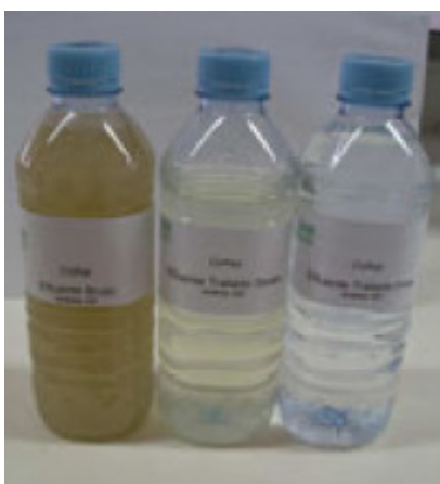
Figura 8-56 – Afluente Bruto, Efluente Intermédio e Efluente Tratado (Ind. Conservas/Gorduras)
