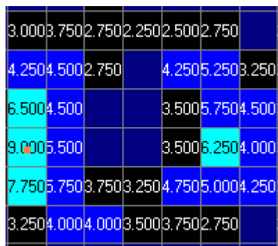
Figura 4.2 – Dados recolhidos pela manta de pressão com o Head-ring (valores em kPa).
