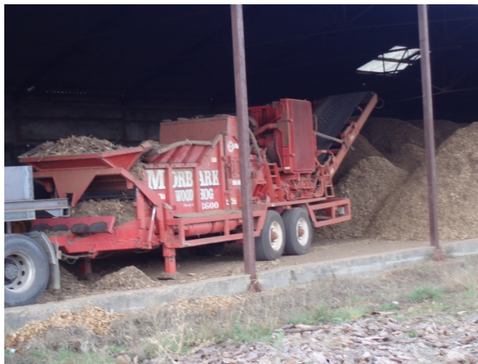
Figura 3.12 Trituração no terminal. A estilha fica armazenada num local sob cobertura, permitindo uma secagem mais rápida.
