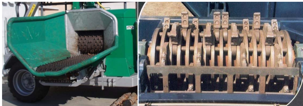
Figura 3.6 Triturador de martelos fixos (esq.) e triturador de martelos livres (dir.) (Fonte: www.gemacosales.com ).
