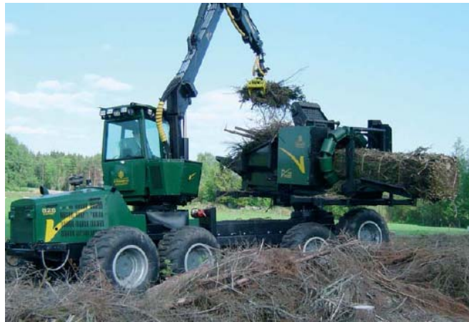
Figura 3.8 Máquina para de produção de fardos (RS2000) montada num forwarder (Fonte: Hakkila, 2004).
