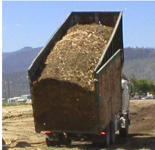
Figura 3.9 Descarga de estilha de um contentor em camião com báscula (Fonte: Rummer, 2005a).
