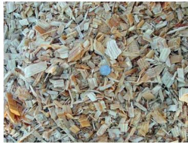
Figura 3.3 Estilha resultante de uma trituração com uma máquina de facas (Fonte: www.barkdelivered.com ).
