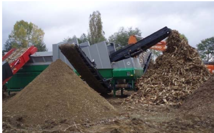
Figura 3.7 Crivagem de estilha proveniente da trituração de cepos. A pilha de estilha (dir.) deverá passar por nova trituração para obter uma estilha de melhor qualidade.
