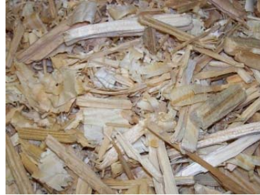
Figura 3.5 Estilha resultante de uma trituração com martelos (Fonte: www.bmandm.com ).
