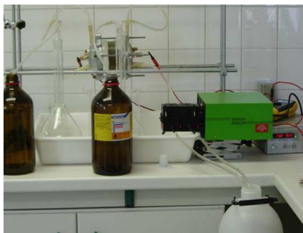
Figura 9.1 Célula e equipamento utilizado nos ensaios electrocinéticos
