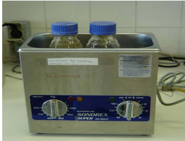
Figura 9.7 Etapa de ultra-sons para remover a bentazona presente nas membranas passivas
