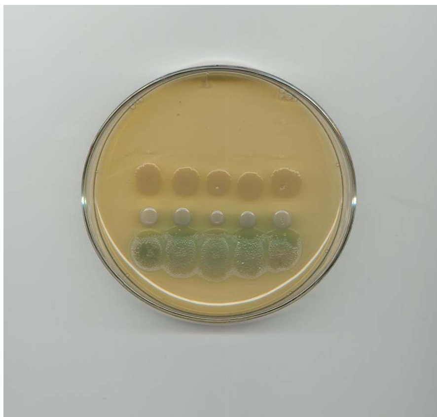
Foto 1: Determinación de la Concentración Inhibitoria Mínima en medio sólido usando MYPGP como medio basal, Tilosina 0,0625 \mu\text{g/ml} . De arriba hacia abajo cepas PL30, PL32 (sin crecimiento ya que son sensibles a la concentración probada), E. coli , S. aureus y P. aeruginosa .
