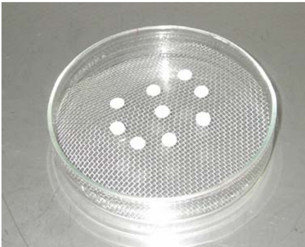
Figura 5: Dispositivo para optimizar el llenado de los discos con ATB.
