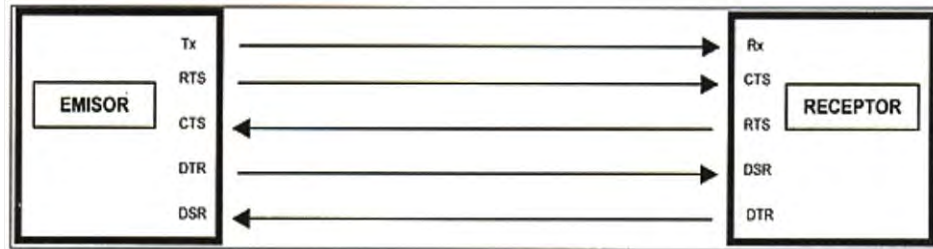
Figura 2.32 Conexiones entre emisor y receptor para el control de flujo por hardware.
