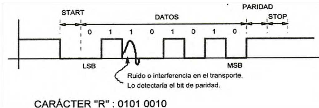
Figura 2.5 Bit de paridad en una transmisión incorrecta, con ruido.
