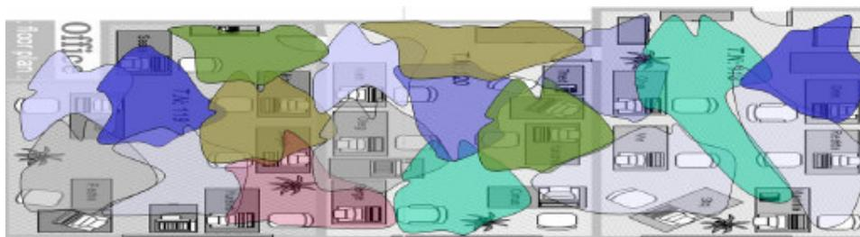
Figura 44: cobertura 802.11n usando microceldas de 5GHz
