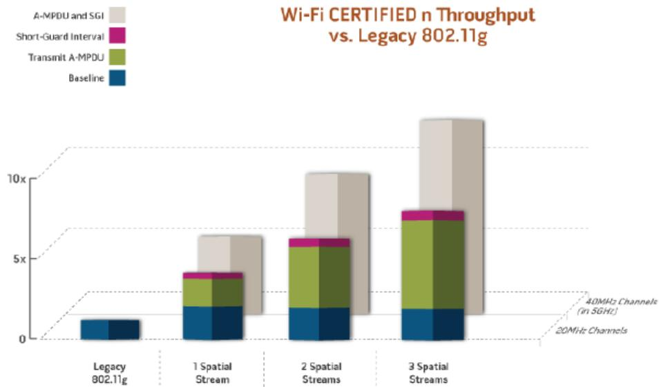
Figura 38: Rendimiento esperado en 802.11n respecto a normas anteriores
