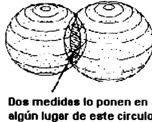
Figura 2.3: Intersección entre esferas con centro en dos satélites.
