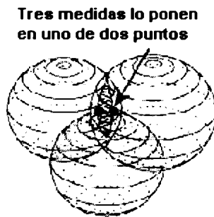
Figura 2.4: Puntos resultantes de la intersección entre tres esferas.
