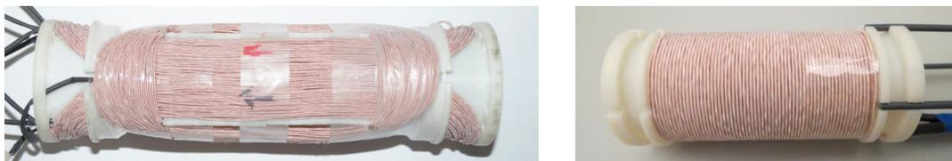
**Abb. 3.3:** Links: Zwei Sattelspulenpaare auf dem gedruckten Träger. Diese werden innerhalb des dLGAs platziert. Rechts: Die MPI-Empfangsspule auf einem gedruckten Träger. Sie wurde so gefertigt, dass sie genau in die Sattelspulen passt.
