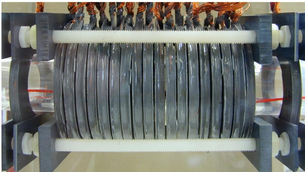
**Abb. 4.1:** Mechanischer Aufbau des dynamischen linearen Gradientenarrays. Abstandhalter aus Teflon erzeugen den nötigen Luftspalt von 1 mm zwischen den Spulen. Durch vier Gewindestangen aus Polyamid erhält das dLGA die nötige Stabilität. Mithilfe der Gewindestangen lassen sich auch die äußersten beiden Spulen in z-Richtung verschieben, um eine optimale Entkopplung der beiden Kanäle zu erreichen.
