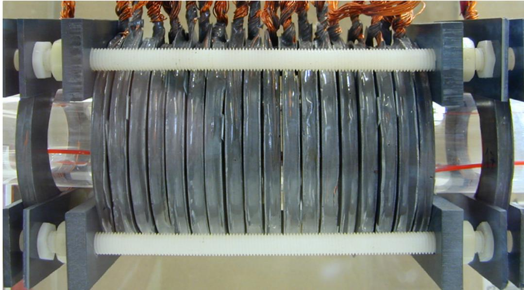
**Abb. D.3:** Mechanischer Aufbau des dynamischen linearen Gradientenarrays. Abstandhalter aus Teflon erzeugen den nötigen Luftspalt von 1 mm zwischen den Spulen. Durch 4 Gewindestangen aus Polyamid erhält das dLGA die nötige Stabilität. Mithilfe der Gewindestangen lassen sich auch die äußersten beiden Spulen in z-Richtung verschieben, um eine optimale Entkopplung der beiden Kanäle zu erreichen.
