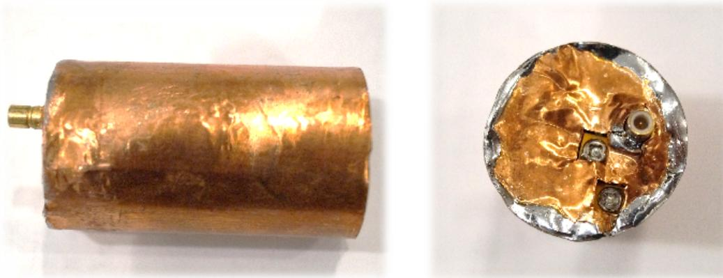
**Abb. 4.11:** Design der MRI-Empfangsspule für den Hybridscanner. Zu sehen ist der Kupferschirm. Der Deckel enthält Öffnungen für die Trimmerkondensatoren und der Boden eine Öffnung für die Probe. Gegenüber dem ursprünglichen Solenoiden, ist diese Spule als Sattelspule gewickelt. Der Durchmesser der Spule beträgt 12,5 mm und die Länge der Spule 18 mm.
