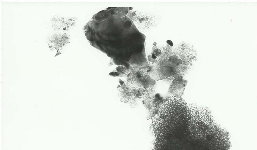
**Figura 4.12.** Micrografía TEM de Ni-Rh/ $\alpha$ -Al<sub>2</sub>O<sub>3</sub>.
