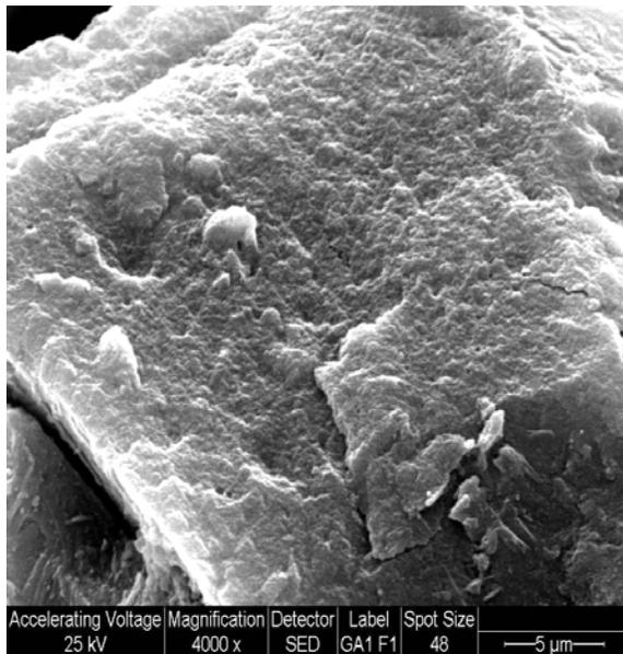
**Fig.4.6.a.** Micrografía SEM de  $\gamma$ -Al<sub>2</sub>O<sub>3</sub>.
