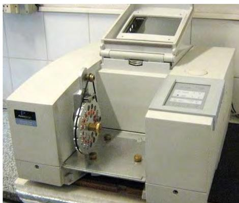
**Fig. 8. Espectrómetro FT-IR.** Imagen del espectrómetro Spectrum One de Perkin-Elmer, empleado para el análisis de las suspensiones bacterianas.
