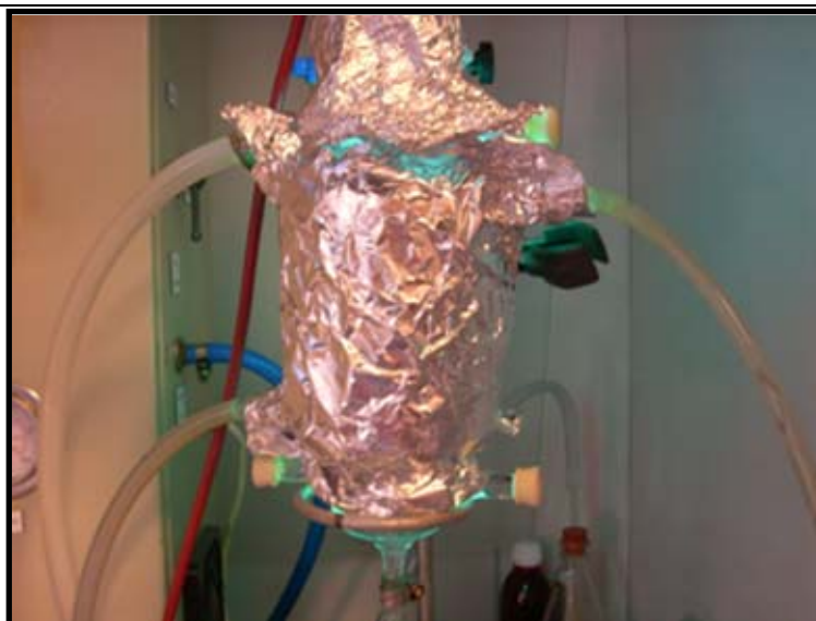
Figura II C. Reactor con lámpara de baja presión de mercurio utilizado para fotólisis continuas UV y UV/ H 2 O 2 .
