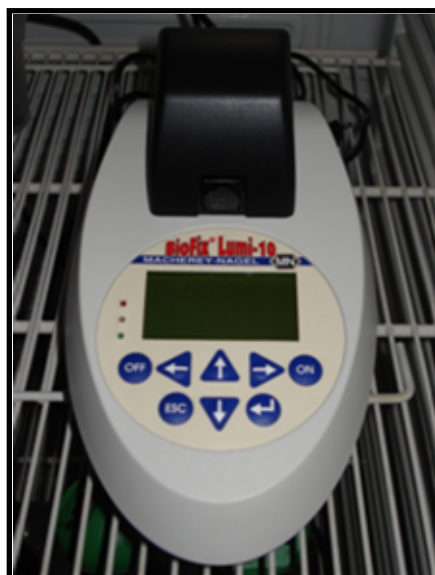
Figura II H. Luminómetro utilizado para los ensayos con bacterias Vibrio fischeri .
