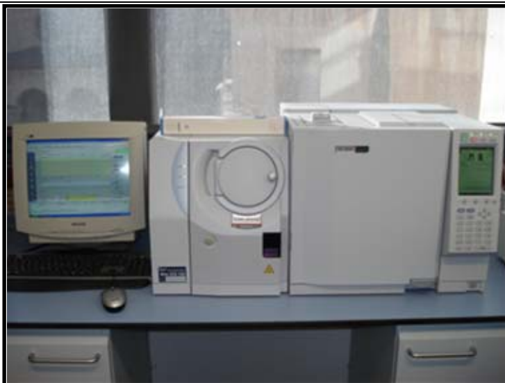
Figura II F. Equipo de cromatografía gaseosa con detector de masas utilizado.
