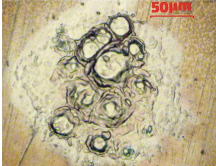
Figura 1: Cráter producido por la ablación de una muestra de cobre metálico con un láser pulsado de 10 nanosegundos. Se puede observar el material redepositado y las crestas formadas.
