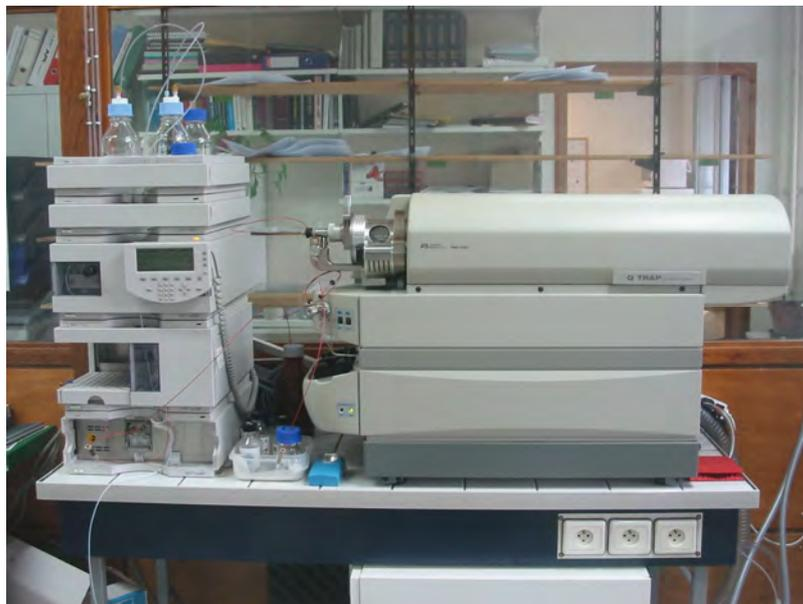
Figura 7.2. Equipamiento utilizado en las determinaciones HPLC-MS
