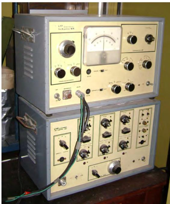
Figura 5.2. Potenciostato utilizado en los experimentos electroquímicos
