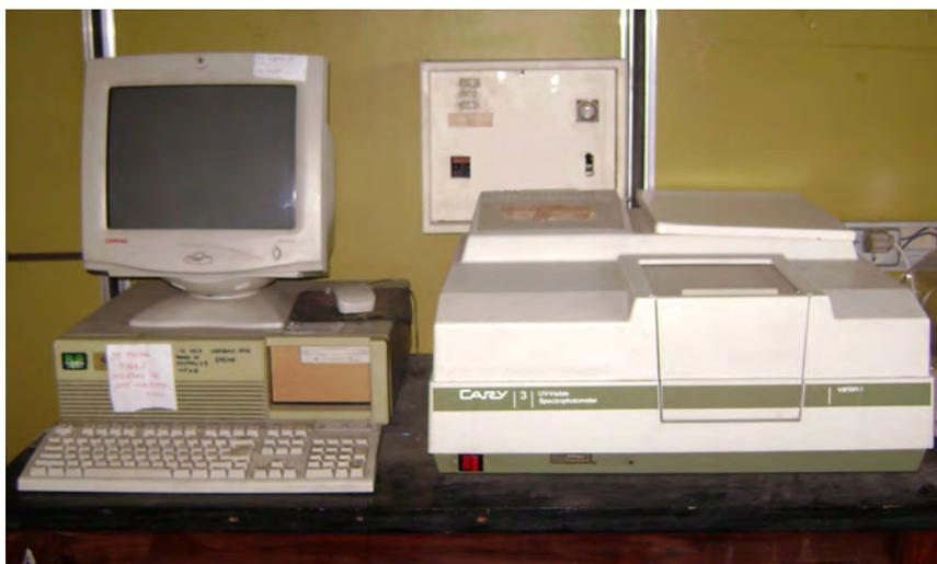
Figura 2.2. Equipo utilizado para las determinaciones espectrofotométricas
