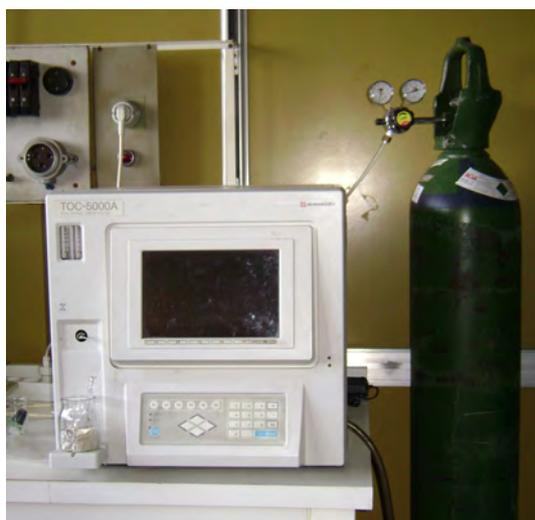
Figura 2.3. Equipo utilizado para las determinaciones de Carbono Orgánico Total
