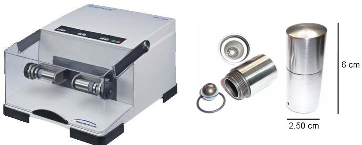
Figura 4.1: Fotografía del molino vibratorio horizontal, similar al empleado para la preparación de las muestras de esta tesis (izq). Cilindros y esferas usados en el proceso de molienda (der).
