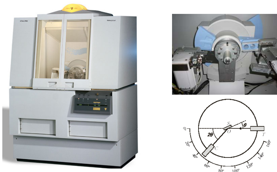
Figura 4.7: Difractómetro Philips X'Pert Pro utilizado para realizar las medidas de difracción de rayos X (izq). Fotografía del goniómetro del difractómetro junto con un esquema de la geometría de trabajo del instrumento (der).
