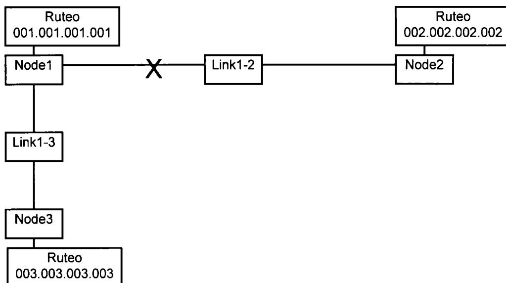
La siguiente muestra es el tráfico de paquetes OSPF en el router 001.001.001.001 (Node1) desde la inicialización del escenario simulado, con la caída de la interface Link1-2 y su posterior reparación.
