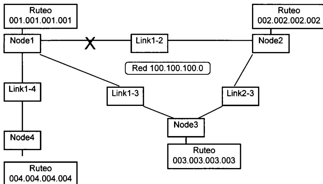
La siguiente muestra es el tráfico de paquetes OSPF en el router 001.001.001.001 (Node1) desde la inicialización del escenario simulado, con la caída de la interface Link1-2 y su posterior reparación.
