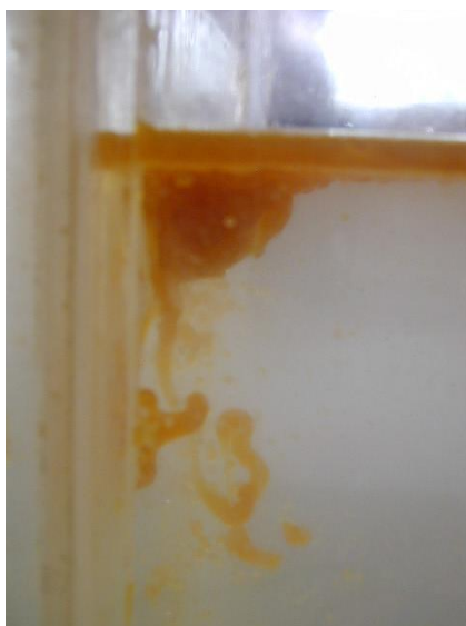
Fig. 3.21. Fenómeno del “rodillo” de aceite observado con los vertedores rectangulares de entrada.
