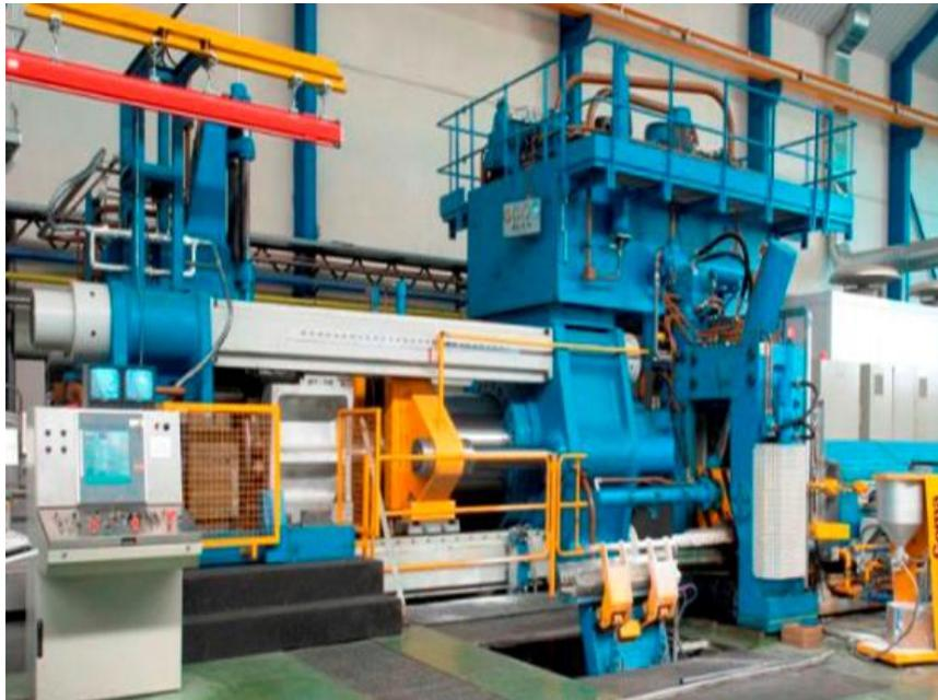
**Imagen 1.** Prensa de extrusión de perfiles de aluminio.
