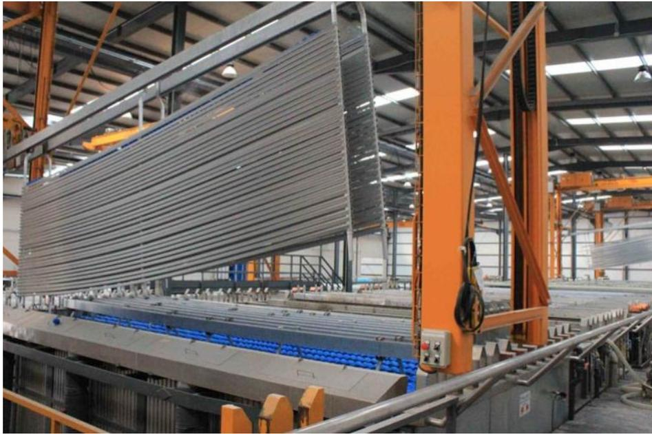
**Imagen 7.** Proceso de anodizado de aluminio.
