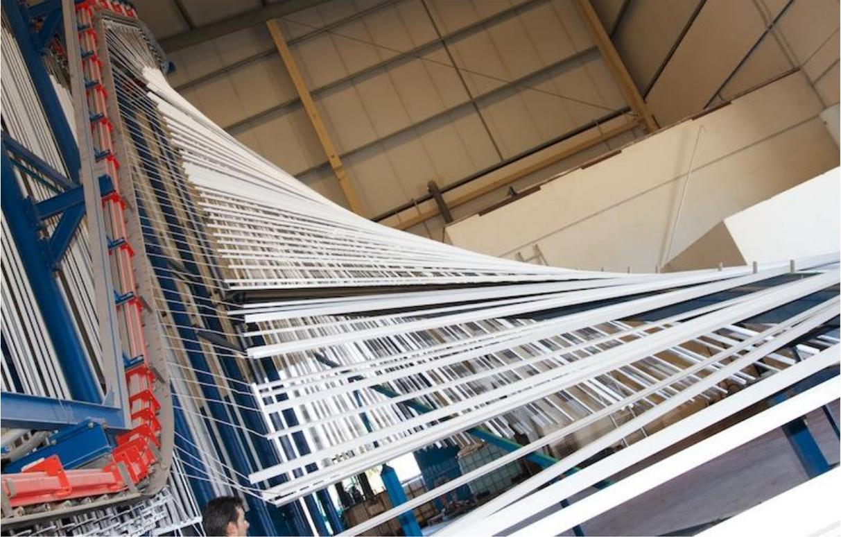
**Imagen 6.** Final del proceso de lacado de aluminio.
