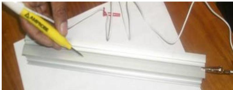
Fotografía 9. Muestra el equipo “Conductímetro” aplicando la prueba a un perfil de aluminio
