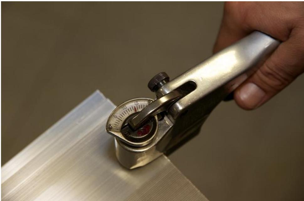
**Imagen 11.** Control de dureza del aluminio.
