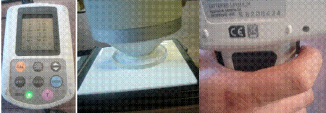
Fotografía 5. Izquierda, muestra la lámpara “ready” encendida, fotografía central, muestra cabezal sobre calibrador, fotografía derecha muestra pulsando botón de medición
