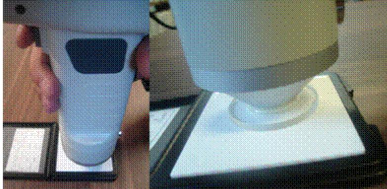
Fotografía 3. Muestra como colocar el Cabezal en la Placa de Calibración
