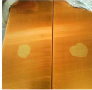
**Fotografía 2. Muestra el Defecto de Sellado Fresco**
