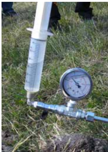
Kuva 2. Bollingin letkuanturin rakenne ja mittausjärjestely. Putken päähän kiinnitetään silikoniletku, joka tulpataan. Maahan porataan reikä vinottain tavoitesyvyyteen ja letku sijoitetaan reikään. Letkuun painetaan espaine lääkeruis- kun avulla, minkä jälkeen hana suljetaan. Maan letkuun kohdistama paine voidaan lukea painemittarista.
