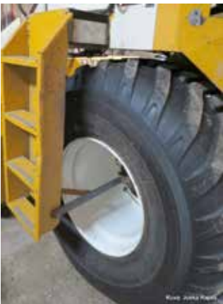
Kuva 23. Muutostyönä portaiden yläpään lisättiin jatkopala ja alapään tukirauta vaihdettiin pitemmäksi.
