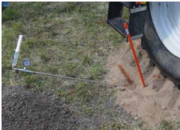
Kuva 2. Bollingin letkuanturin rakenne ja mittausjärjestely. Putken päähän kiinnitetään silikoniletku, joka tulpataan. Maahan porataan reikä vinottain tavoitesyvyyteen ja letku sijoitetaan reikään. Letkuun painetaan espaine lääkeruis- kun avulla, minkä jälkeen hana suljetaan. Maan letkuun kohdistama paine voidaan lukea painemittarista.
