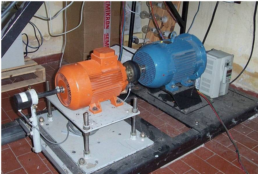
Figura C.5 Banco de ensayos del generador de inducción con el accionamiento eléctrico.
