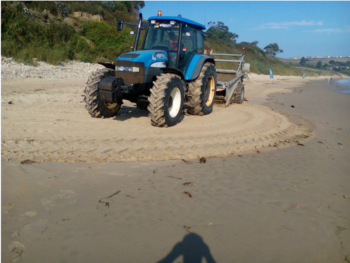
Fig. 18 Tractor con cribadora manteniendo la distancia de seguridad al margen del arenal.
