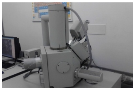
Figuras 46 y 47. Servicio de microscopía electrónica de barrido y microanálisis del LIMF (Laboratorio de Investigación de Metalúrgica Física) Facultad de Ingeniería – UNLP
