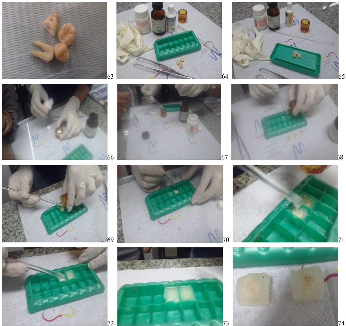
Fig. 63 a 74. Elaboración de las probetas de acrílico en cubetas plásticas con inclusión de las unidades experimentales y posteriores retiro.
