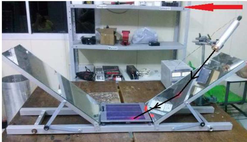
Figura 3 – Determinação experimental da função de aceitação angular.
