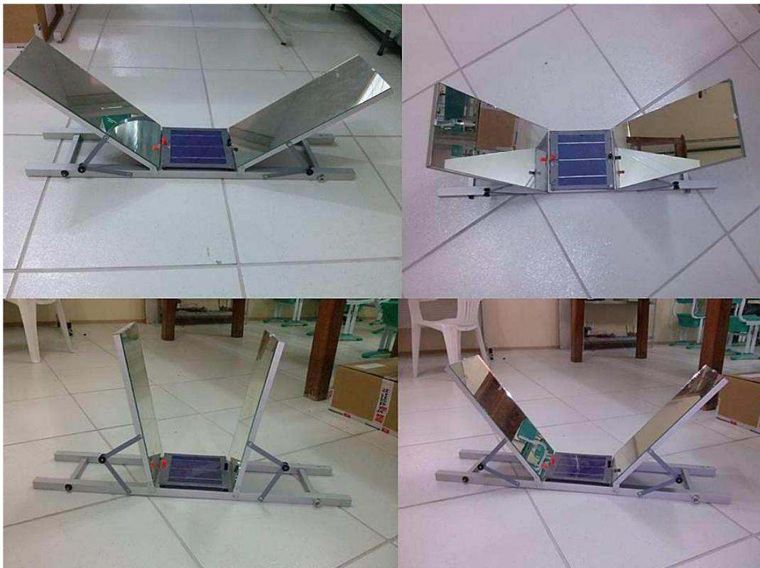
*Figura 1: Concentrador solar tipo V desenvolvido.*
