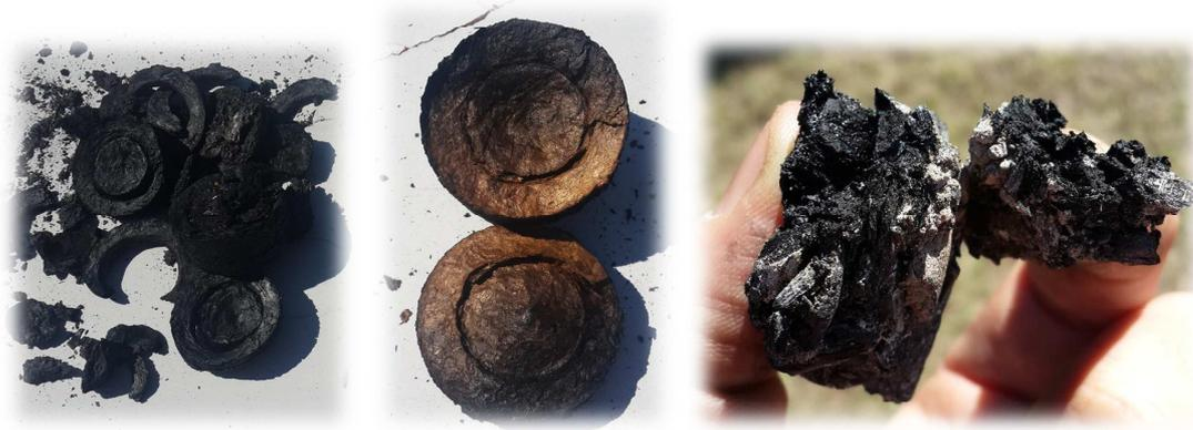
Figura 11: Material post gasificación: Briquetas (izq.); y pino (der.)
