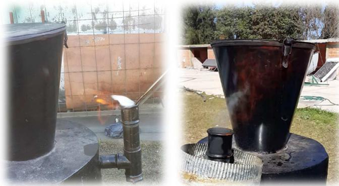
*Figura 10: Generación de syngas evidenciada por la llama: Ensayo con briquetas (izq.); y con pino (der.)*
