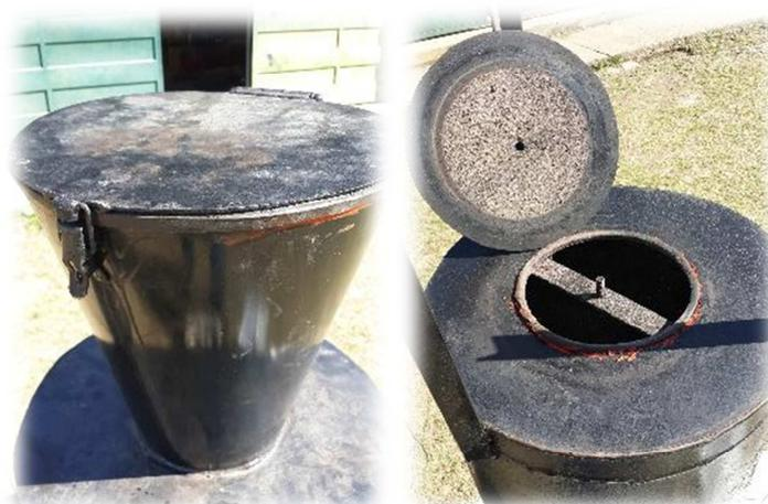
*Figura 2: Detalle tobera, tapa y burletes en parte superior del gasificador (izq.); detalle tapa y burletes en parte inferior (der.).*
