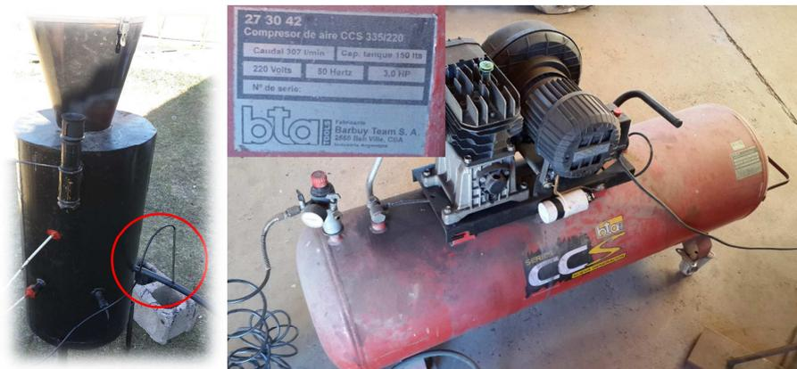
Figura 6: Ubicación del anemómetro de hilo caliente (izq.); compresor de aire (der.).
